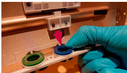
Figura 20 Rimuovere l'anello colorato danneggiato
