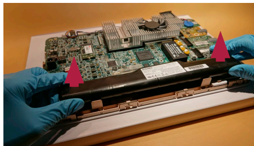
Abbildung 14 Entfernen des Akkus
