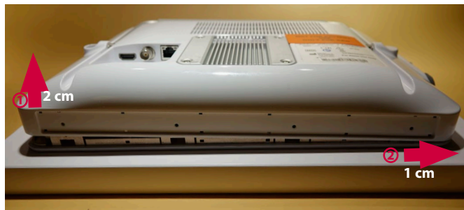
Obrázok 9 Opatrne potiahnite zadné puzdro nahor a posuňte ho mierne doprava
