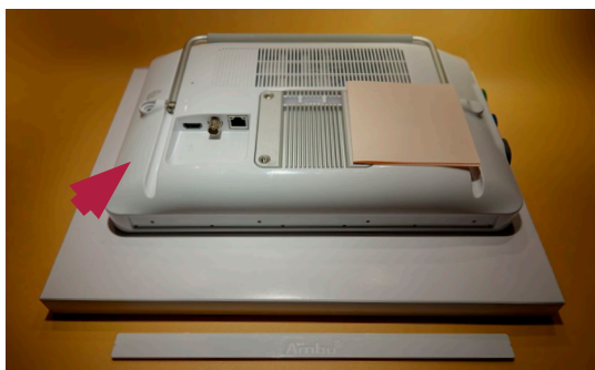
Фигура 8 Поставяне на дисплейния модул с лицевата страна надолу
