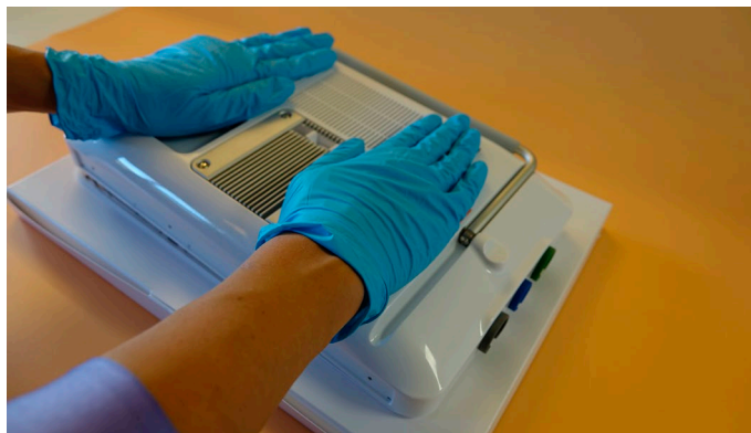
Obrázek č. 32 Zatlačení zadního krytu – západky musí zaklapnout na své místo
