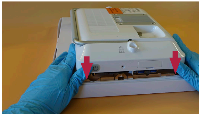
Abbildung 31 Anbringen der rückseitigen Verkleidung, Fortsetzung
