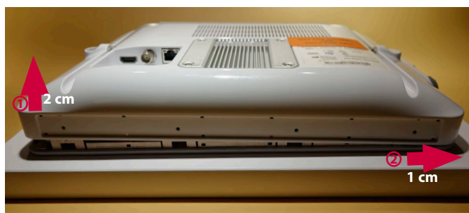
Slika 9: Previdno povlecite zadnje ohišje navzgor in ga potisnite rahlo v desno
