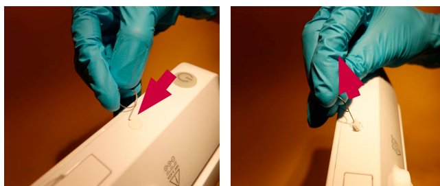
5 pav. Varžto gaubtelio nuėmimas
