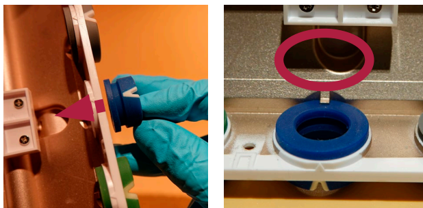
Obrázek č. 21 Zasunutí nového barevného kroužku
