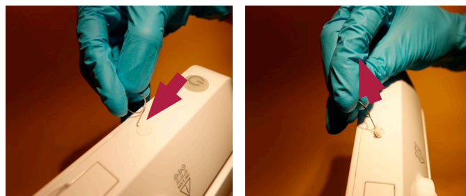
Joonis 5. Kruvikatte eemaldamine
