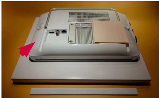
Afbeelding 8 Plaats de weergave-eenheid omlaag gericht
