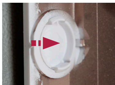
Figure 22 - Installation de la protection si la carte VDI a été retirée
