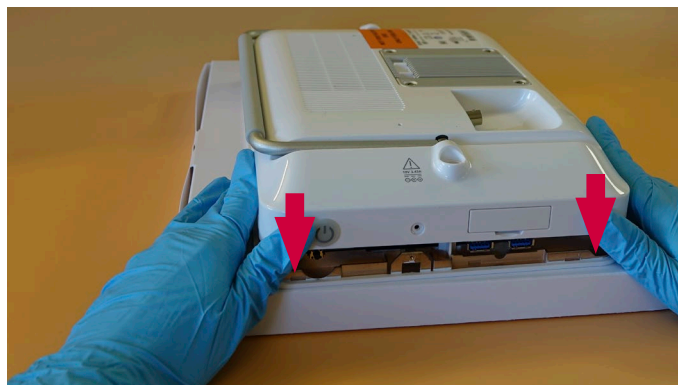
図31 背面ケーシングに取り付ける(続き)
