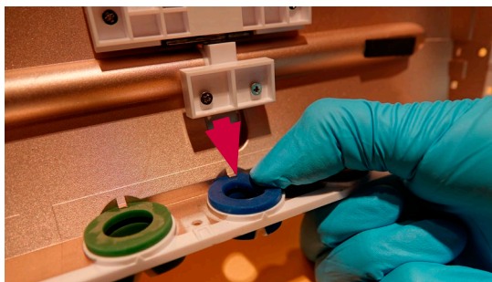
Figura 20 Remover o anel colorido danificado
