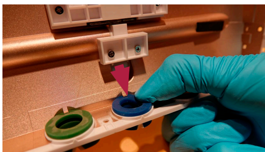
Slika 20. Uklanjanje oštećenog prstena u boji
