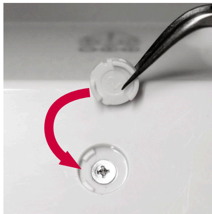
Rysunek 34 Zatrzasnąć osłony śrub
