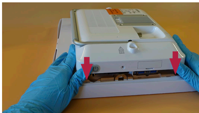
Slika 31. Postavljanje stražnjeg kućišta, nastavak
