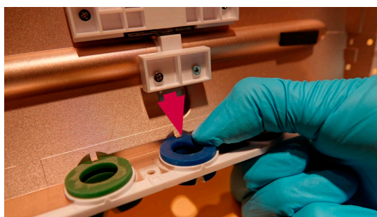
Рис. 20. Снятие поврежденного цветного кольца
