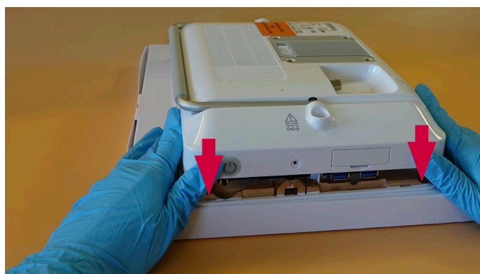
Figura 31 Așezați carcasa dorsală, continuare.
