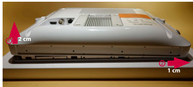
图 9 小心地向上提起后壳并将稍微向右滑动
