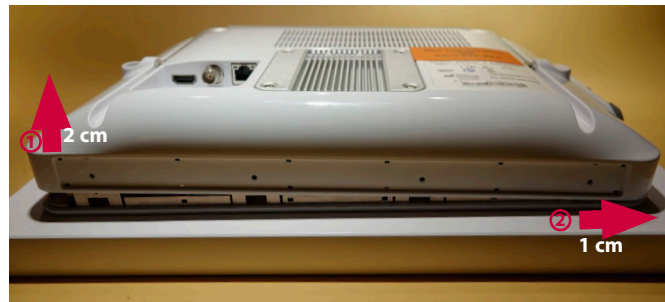
Figura 9 Tirare con cautela l'alloggiamento posteriore verso l'alto e farlo scorrere leggermente verso destra
