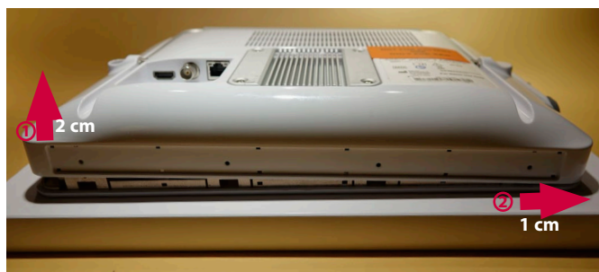
Figur 9 Trekk bakdekselet forsiktig oppover og før det litt mot høyre
