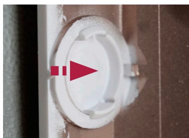
22. ábra: Ha eltávolította a VDI-kártyát, helyezze be a takarót
