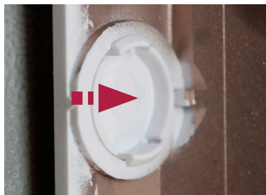
Joonis 22. Kui visualiseerimisseadme liidese plaat on eemaldatud, paigaldage kate
