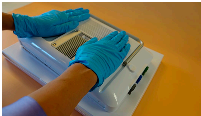
Slika 32: Pritisnite na zadnje ohišje, da se zaskoči na mesto
