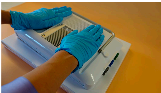
Slika 32. Pritisnite stražnje kućište tako da sjedne na mjesto
