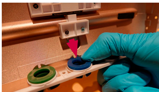
Afbeelding 20 Verwijder de beschadigde kleurring
