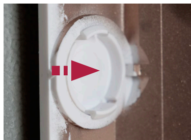
Εικόνα 22 Εγκατάσταση του καλύμματος εάν η κάρτα VDI έχει αφαιρεθεί
