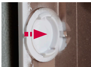
図22 VDIボードが取り外された場合、カバーを取り付ける
