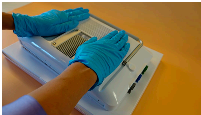
Figura 32 Presione hacia abajo la carcasa trasera hasta que haga clic y quede fija en su posición
