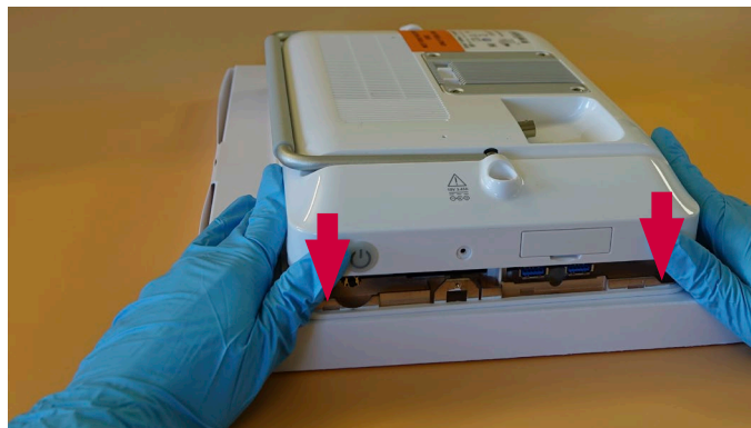
Figura 31 Colocar a caixa traseira, continuação
