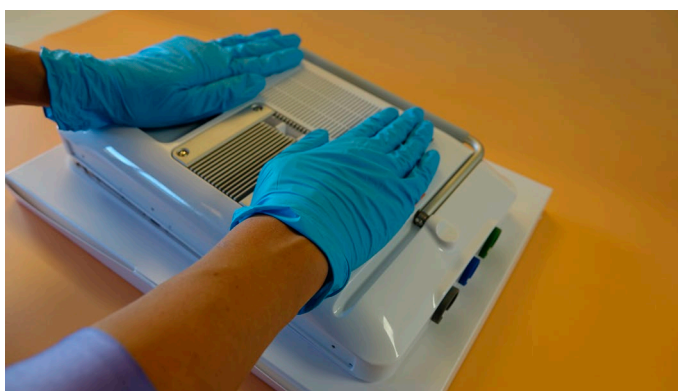
Figura 32 Apăsați pe carcasa dorsală până când se fixează în poziție cu un clic
