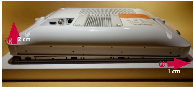
Şekil 9 Arka kasayı dikkatli bir şekilde kaldırın ve hafifçe sağa kaydırın
