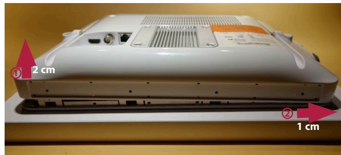
Abbildung 9 Die rückseitige Verkleidung wird vorsichtig nach oben gezogen und etwas nach rechts geschoben
