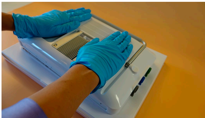
Figur 32 Trykk ned bakdekselet til det klikker på plass
