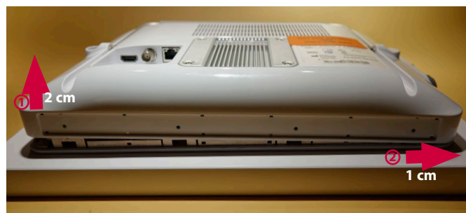
9 pav. Atsargus nugarėlės atkėlimas į viršų ir nežymus pastūmimas į dešinę
