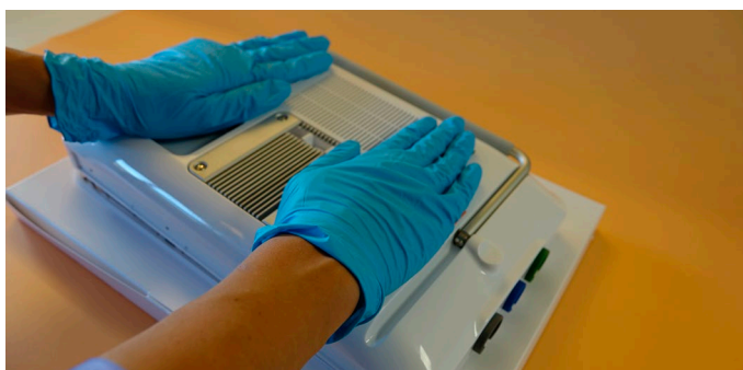
Bild 32 Tryck på höljets baksida tills det snäpper på plats
