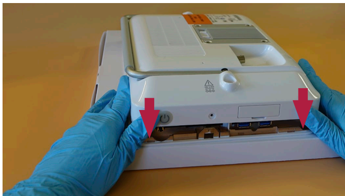
Joonis 31. Asetage korpuse tagakülg tagasi, järg
