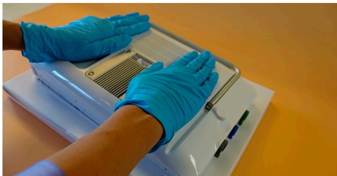
Şekil 32 Yerine oturana kadar arka kasaya bastırın
