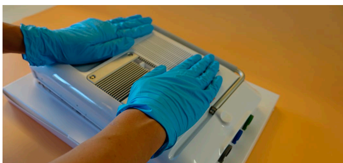
Рис. 32. Прижмите заднюю крышку корпуса до щелчка
