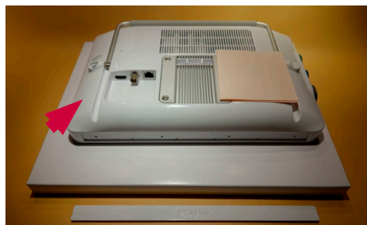
Figura 8 Posizionare l'unità display rivolta verso il basso
