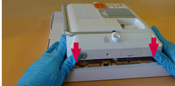
Şekil 31 Arka kasayı yerleştirin, devamı
