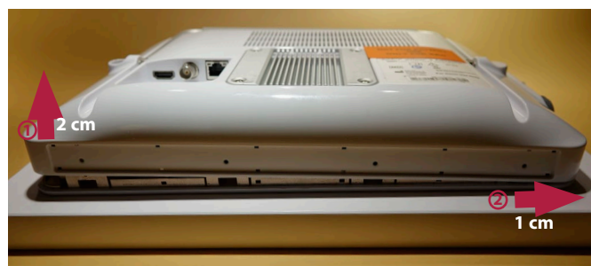
Kuva 9 Nosta takakotelo varovasti ylöspäin ja siirrä sitä vähän oikealle
