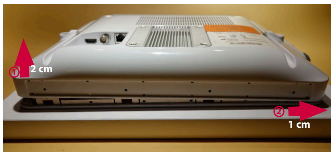
Figura 9 Elevar cuidadosamente a caixa traseira e deslizar ligeiramente para a direita
