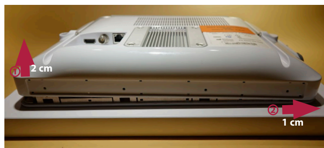
Figura 9 Tire con cuidado de la carcasa trasera hacia arriba y deslícela ligeramente hacia la derecha
