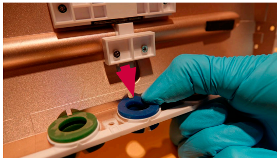
20 pav. Sugadinto spalvoto žiedo nuėmimas
