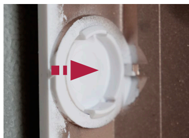
Abbildung 22 Die Abdeckung wird angebracht, wenn die VDI-Karte entfernt wurde
