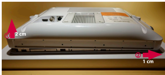
Bild 9 Dra försiktigt höljets baksida uppåt och skjut det lite åt höger
