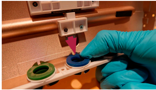
Εικόνα 20 Αφαίρεση του κατεστραμμένου έγχρωμου δακτυλίου
