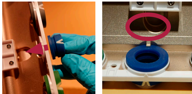
Figure 21 - Insertion d'un nouvel anneau de couleur
