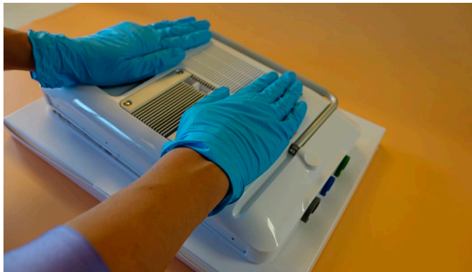
Abbildung 32 Drücken Sie die rückseitige Verkleidung nach unten, bis sie einrastet
