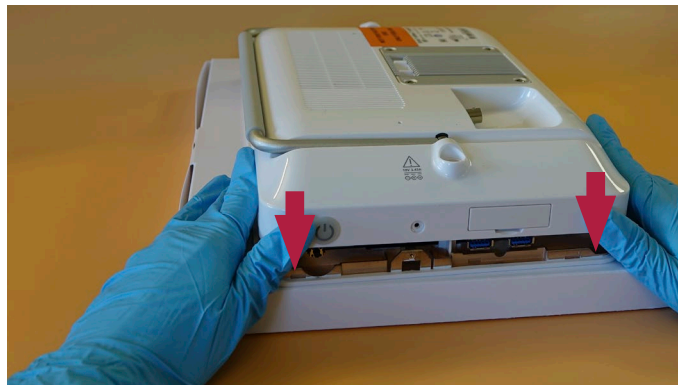
Figure 31 - Mise en place du boîtier arrière (suite)
