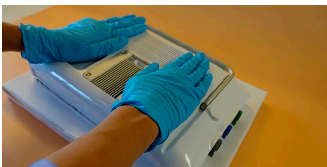
Rysunek 32 Dociśnij tylną obudowę, aż usłyszysz kliknięcie.
