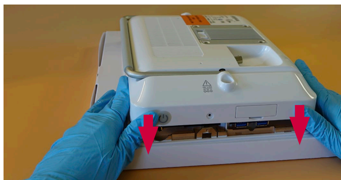
Рис. 31. Установка задней крышки, продолжение
