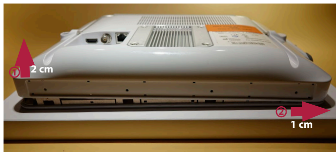
9. ábra: Óvatosan húzza felfelé a hátsó burkolatot, majd tolja egy kissé jobbra
