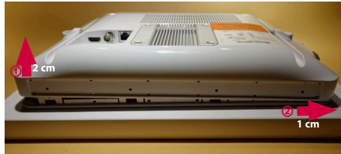
Rysunek 9 Ostrożnie podnieść tylną obudowę i przesunąć ją nieznacznie w prawo
