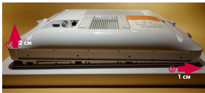
Рис. 9. Осторожно поднимите заднюю крышку корпуса и немного сдвиньте ее вправо
