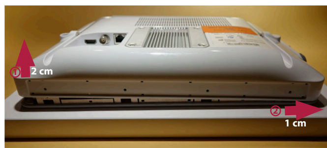
Obrázek č. 9 Nadzvednutí zadního krytu a mírné posunutí doprava
