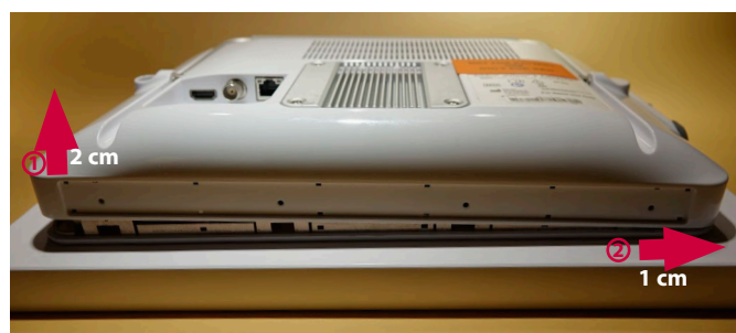
図9 背面ケースを慎重に引き上げ、わずかに右にスライドさせる
