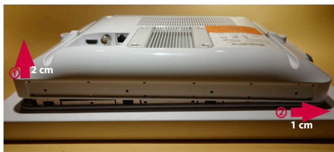
Afbeelding 9 Trek de achterbehuizing voorzichtig omhoog en schuif enigszins naar rechts
