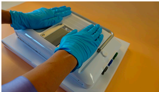
Figura 32 Premere sull'alloggiamento posteriore finché non scatta in posizione
