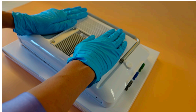
Afbeelding 32 Druk de achterbehuizing omlaag tot deze op zijn plaats vastklikt
