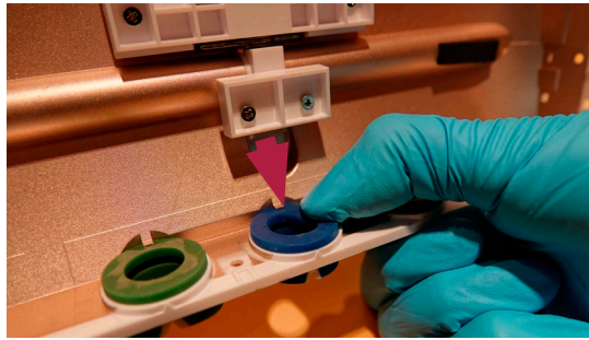
Abbildung 20 Entfernen des beschädigten Farbrings
