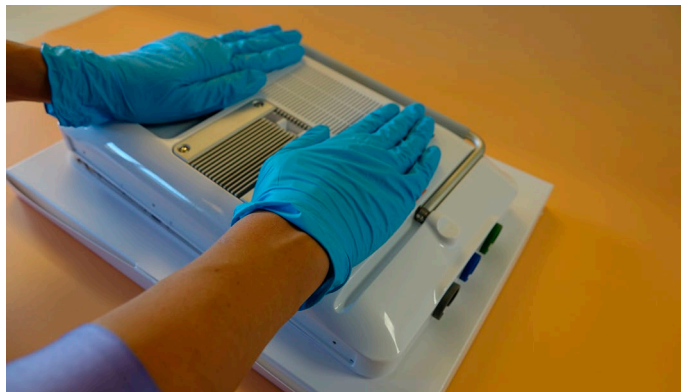
Kuva 32 Paina takakoteloä niin, että se napsahtaa paikalleen
