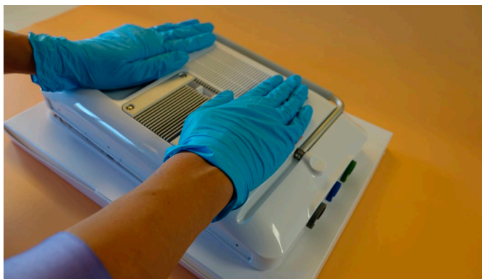
Εικόνα 32 Πιέστε προς τα κάτω το πίσω περίβλημα μέχρι να ασφαλίσει στη θέση του
