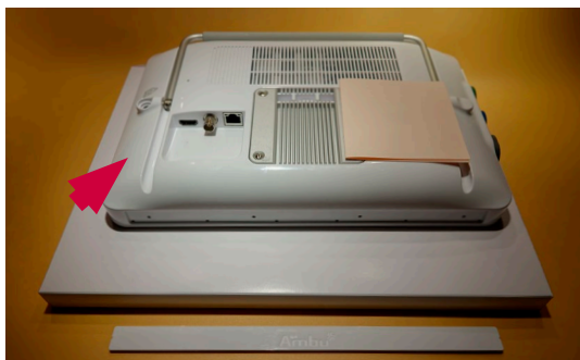
Figur 8 Plasser skjermenheten med skjermen ned
