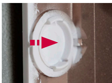
Slika 22: Namestitev pokrova, če je bila plošča VDI odstranjena
