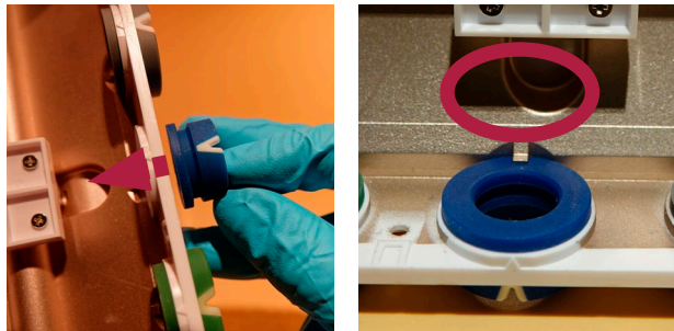
Εικόνα 21 Εισαγωγή νέου έγχρωμου δακτυλίου
