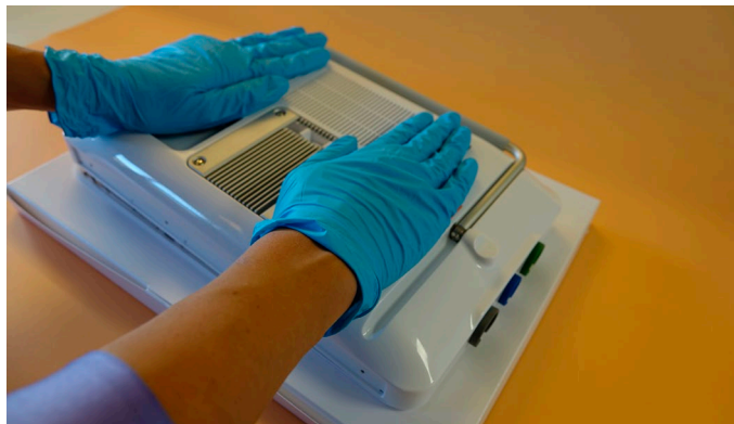
32 pav. Nugarėlės įspaudimas, kol ji užsifikuos reikiamoje vietoje
