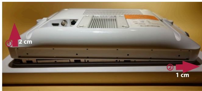
Figur 9 Løft forsigtigt bagbeklædningen opad, og skub den lidt til højre
