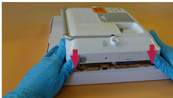
Obrázek č. 31 Nasazení zadního krytu zpět – pokračování
