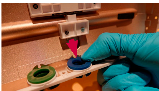
Slika 20: Odstranitev poškodovanega barvnega obročka
