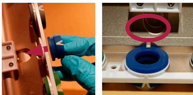
Joonis 21. Sisestage uus värvirõngas
