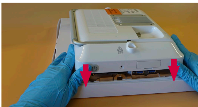
Rysunek 31 Zakładanie tylnej obudowy, ciąg dalszy
