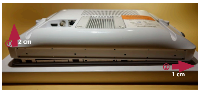
Фигура 9 Внимателно издърпване нагоре и леко плъзгане надясно на задния корпус
