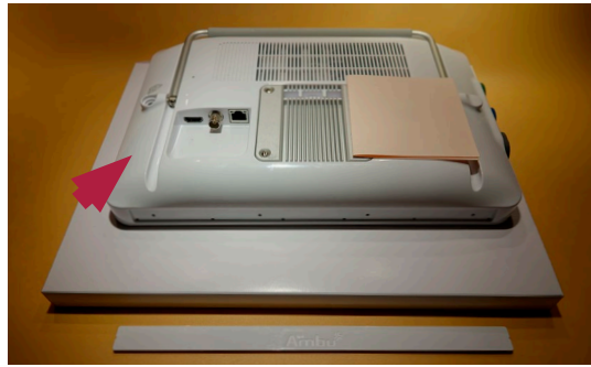
Figure 8 - Écran positionné face avant vers le bas
