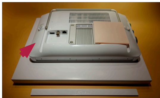
Εικόνα 8 Τοποθέτηση της μονάδας προβολής στραμμένη προς τα κάτω
