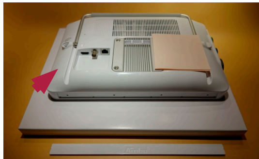
Kuva 8 Aseta näyttöyksikkö näyttö alaspäin
