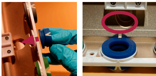
21. ábra: Helyezzen be új színes gyűrűt
