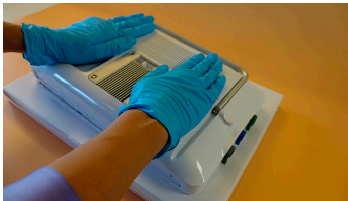
Figure 32 - Appuyer sur le boîtier arrière jusqu'à ce qu'il s'enclenche
