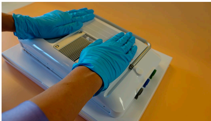
32. ábra: Nyomja lefelé a hátsó burkolatot úgy, hogy a helyére pattanjon
