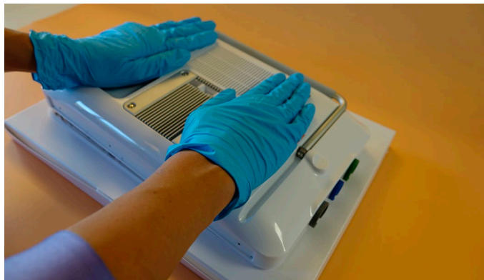
Figur 32 Tryk bagbeklædningen ned, indtil den klikker på plads
