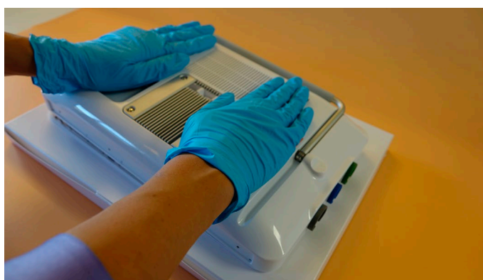
Joonis 32. Vajutage korpuse tagakülg alla, kuni see klõpsatusega oma kohale kinnitub
