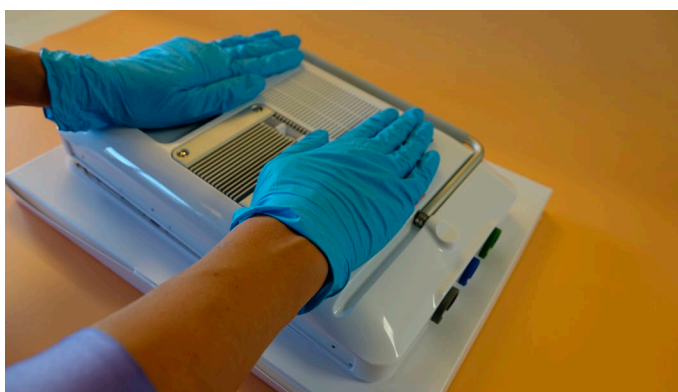
Фигура 32 Натискане на задния корпус надолу, докато щракне на място
