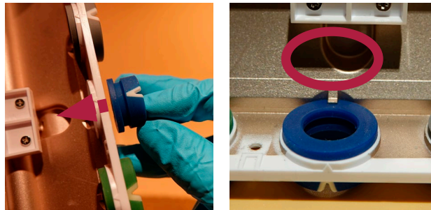
Abbildung 21 Einfügen eines neuen Farbrings
