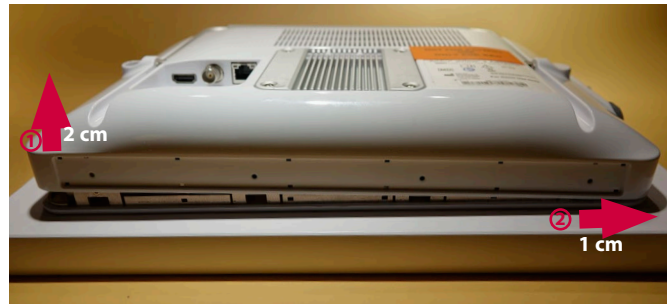
Figura 9 Trageți cu atenție carcasa dorsală în sus și glisați-o puțin către dreapta.
