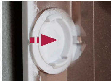
Kuva 22 Suojuksen asentaminen, jos VDI-kortti on irrotettu
