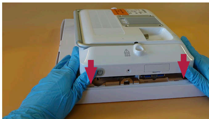
Kuva 31 Takakotelon laittaminen paikalleen, jatkuu
