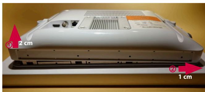
9. attēls. Uzmanīgi pavelciet aizmugurējo korpusu uz augšu un nedaudz pabīdiet to pa labi
