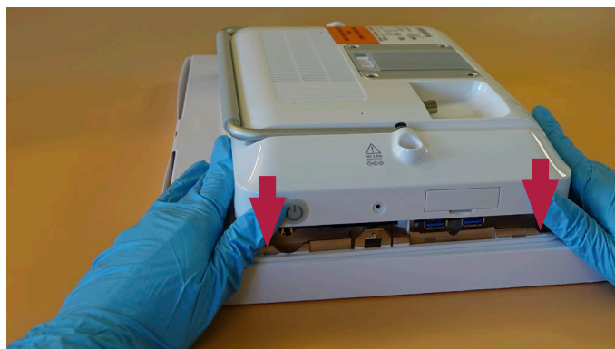
Фигура 31 Поставяне на задния корпус, продължение
