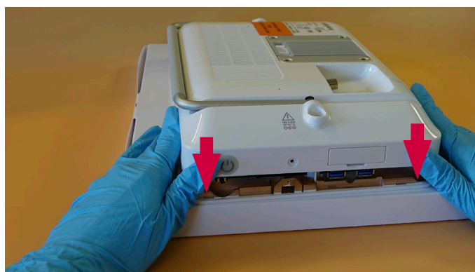
Slika 31: Namestitev zadnjega ohišja, nadaljevanje
