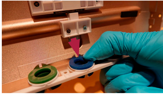
Figure 20 - Retrait d'un anneau de couleur endommagé
