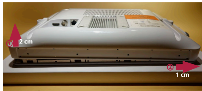
Figure 9 - Soulever doucement le boîtier arrière et le faire glisser légèrement vers la droite
