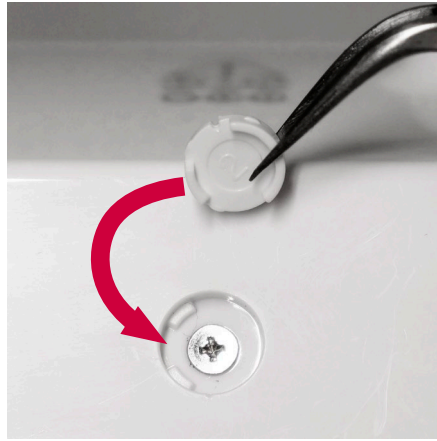
图 34 将螺钉盖卡入到位
