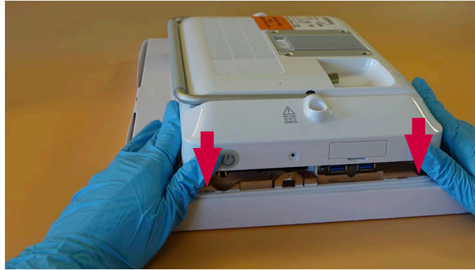
Figura 31 Posizionamento dell'alloggiamento posteriore, continua
