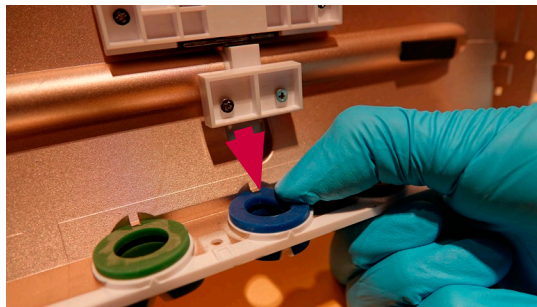
Şekil 20 Hasarlı renkli halkayı çıkarın
