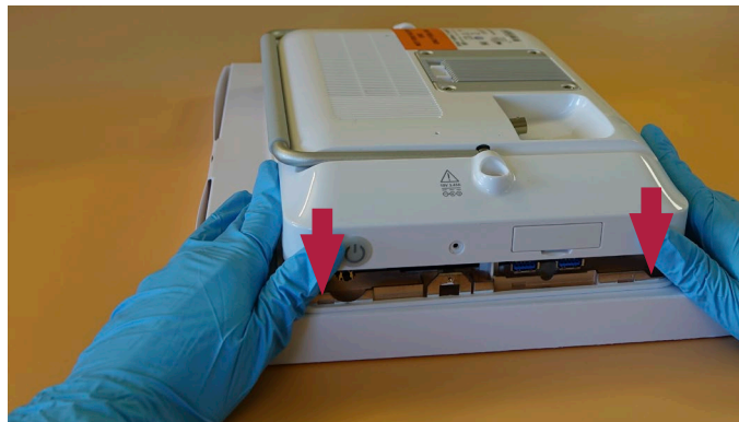
31. ábra: Helyezze fel a hátsó burkolatot – folytatás
