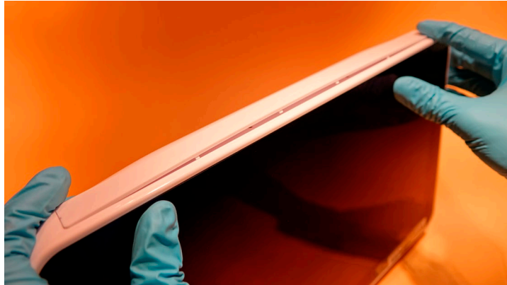
Bild 33 Tryck namnplattorna på plats
