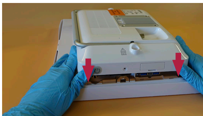
Εικόνα 31 Τοποθέτηση του πίσω περιβλήματος, συνέχεια
