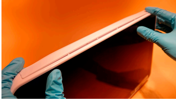
Rysunek 33 Zatrzasnąć tabliczki znamionowe
