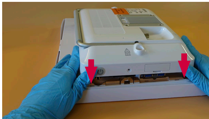
Obrázok 31 Umiestnite zadné puzdro, pokračovanie
