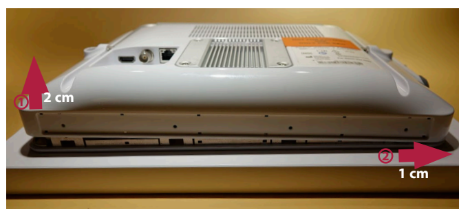
Εικόνα 9 Τραβήξτε προσεκτικά το πίσω περίβλημα προς τα επάνω και σύρετέ το ελαφρώς προς τα δεξιά
