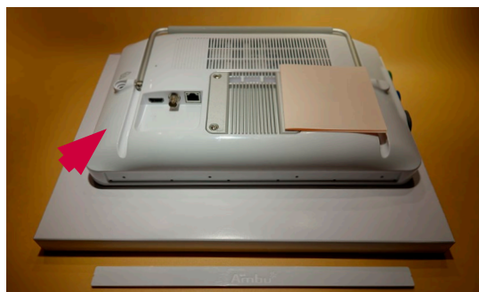
Bild 8 Lägg skärmenheten med skärmen vänd nedåt
