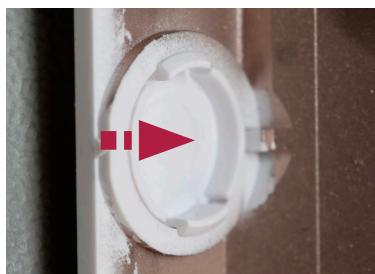
Figur 22 Installér dækslet, hvis VDI-kortet af en eller anden grund er blevet fjernet
