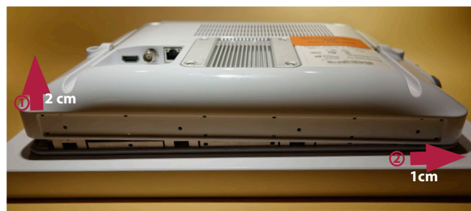
Joonis 9. Tõmmake korpuse tagakülge ettevaatlikult ülespoole ja libistage seda kergelt paremale
