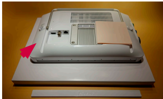
Slika 8: Namestitev monitorja z zaslonom dol
