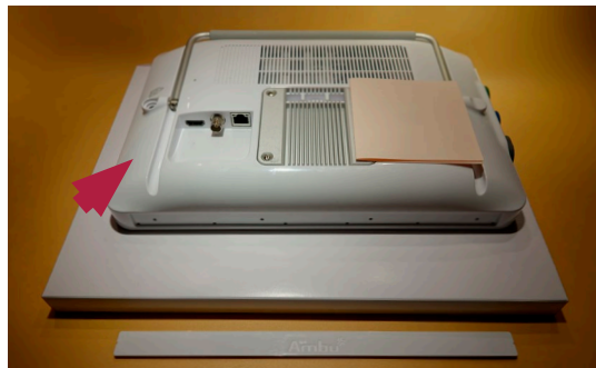
Figura 8 Colocación de la unidad de visualización orientada hacia abajo
