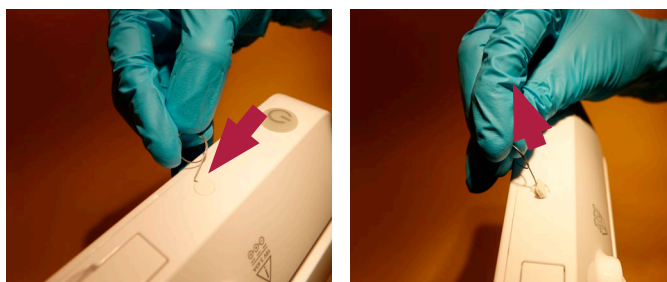
Slika 5. Uklanjanje pokrova za vijak
