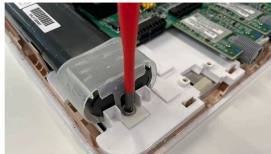
16. ábra: Csavarja ki a csavart az akkumulátor két oldalán
