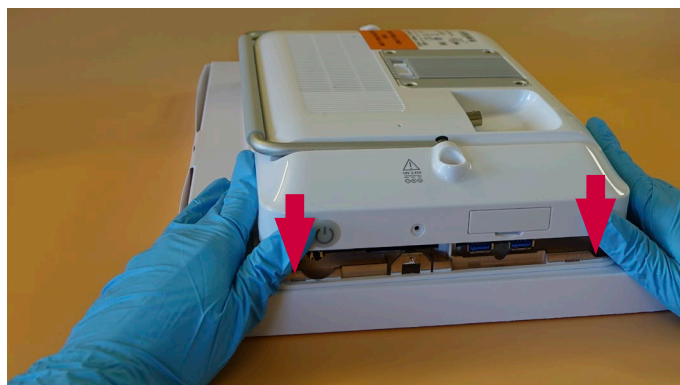
Obrázek č. 36 Nasazení zadního krytu zpět – pokračování
