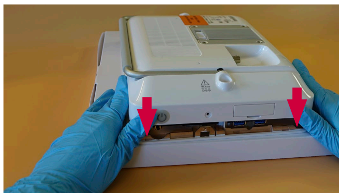
図36 背面ケーシングに取り付ける(続き)
