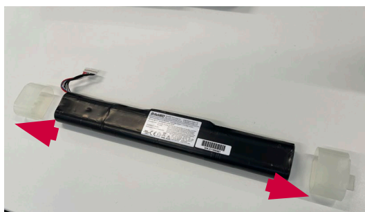
Figura 17 Retirar cuidadosamente as tampas da bateria
