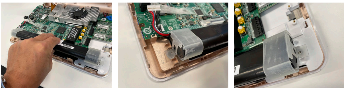
Afbeelding 19 Plaats de batterij met batterijdoppen terug op het apparaat
