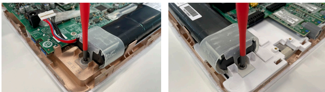
図16 バッテリー両側のネジを外す
