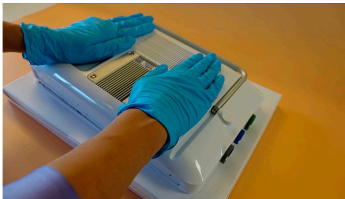
Obrázok 37 Zatlačte nadol na zadný kryt, kým nezacvakne na svojom mieste
