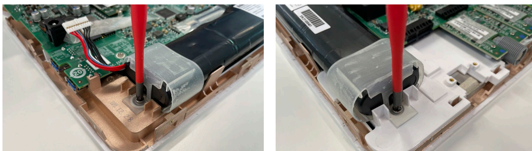
Figura 16 Desapertar os parafusos de ambos os lados da bateria
