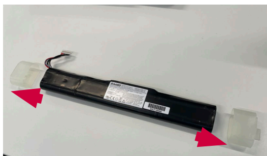
Joonis 17. Akukatete eemaldamine
