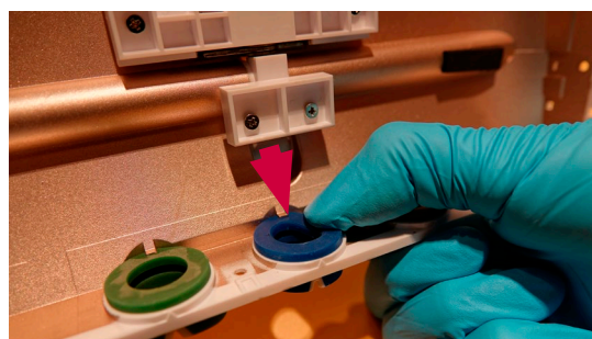
図25 破損したカラーリングの取り外し
