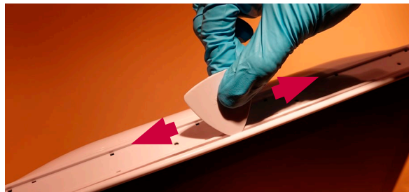
Kuva 7 Takakotelon irrottaminen plektratyökalulla
