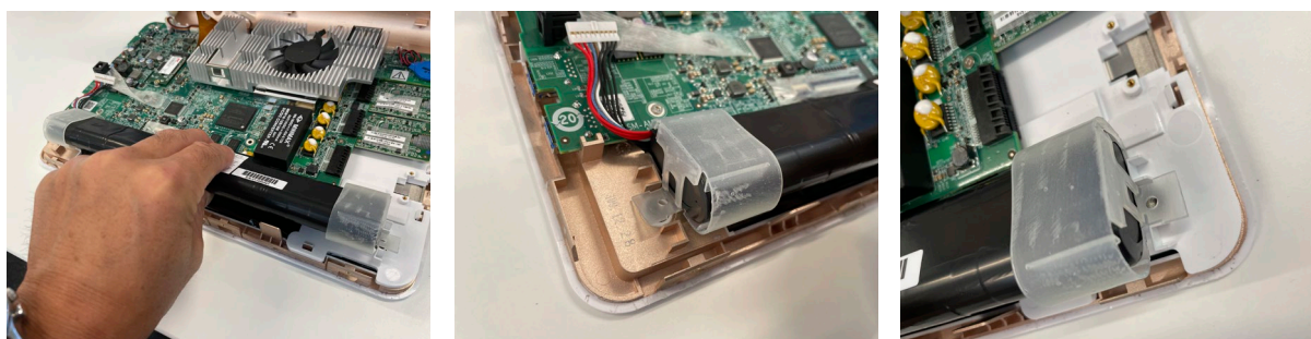
Figur 19 Sett batteridekslene på enheten igjen
