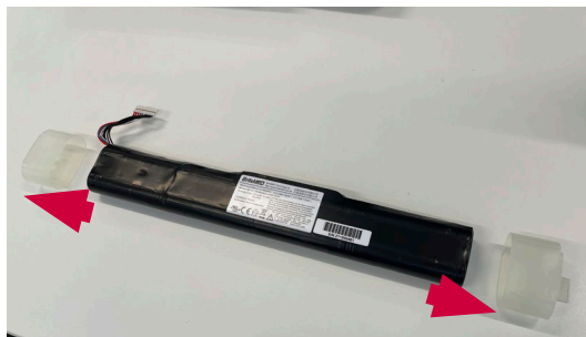
Bild 17 Ta försiktigt bort batterilocken
