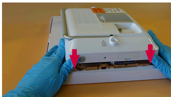
Figura 36 Posizionamento dell'alloggiamento posteriore, continua
