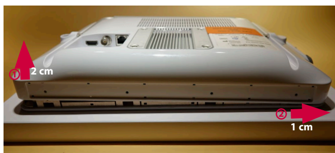
Figura 9: Desplazamiento con cuidado de la carcasa trasera hacia arriba y deslizamiento ligero hacia la derecha
