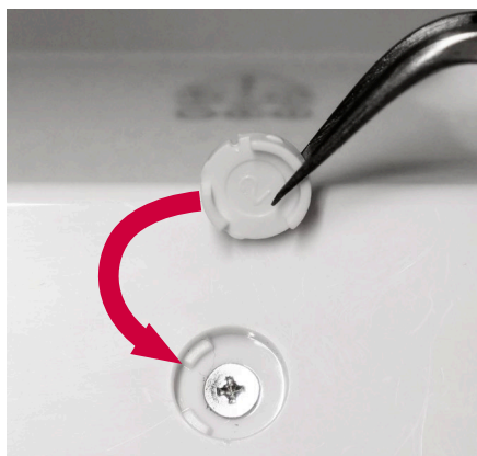
Afbeelding 39 Klik de schroefafdekkingen op hun plaats
