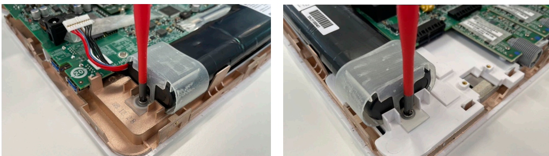
Εικόνα 16 Ξεβιδώστε τις βίδες και στις δύο πλευρές της μπαταρίας
