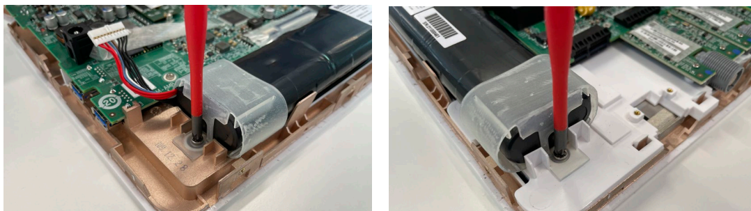
图 16 拧下电池两侧的螺钉
