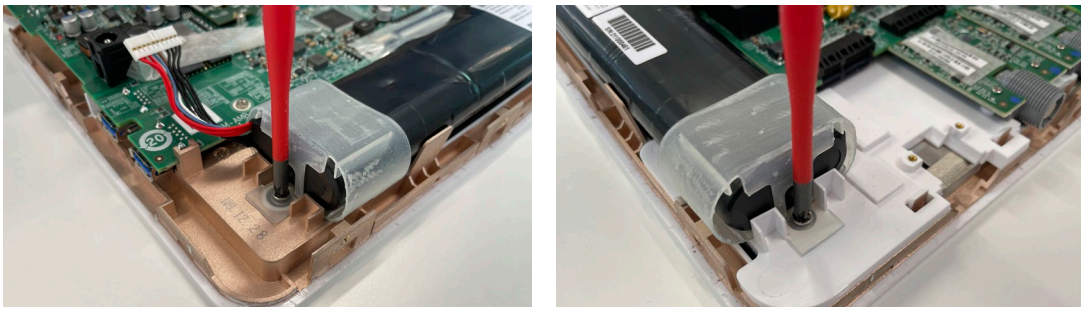
Afbeelding 16 Draai de schroeven aan beide zijden van de batterij los
