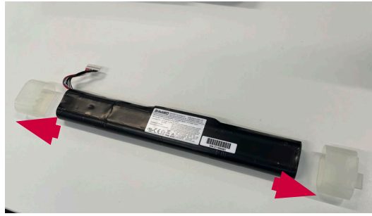
Abbildung 17 Vorsichtiges Entfernen der Akkudeckel
