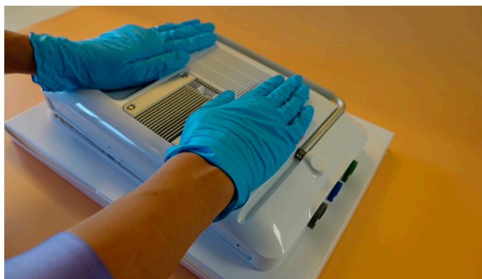
Εικόνα 37 Πιέστε προς τα κάτω το πίσω περίβλημα μέχρι να ασφαλίσει στη θέση του
