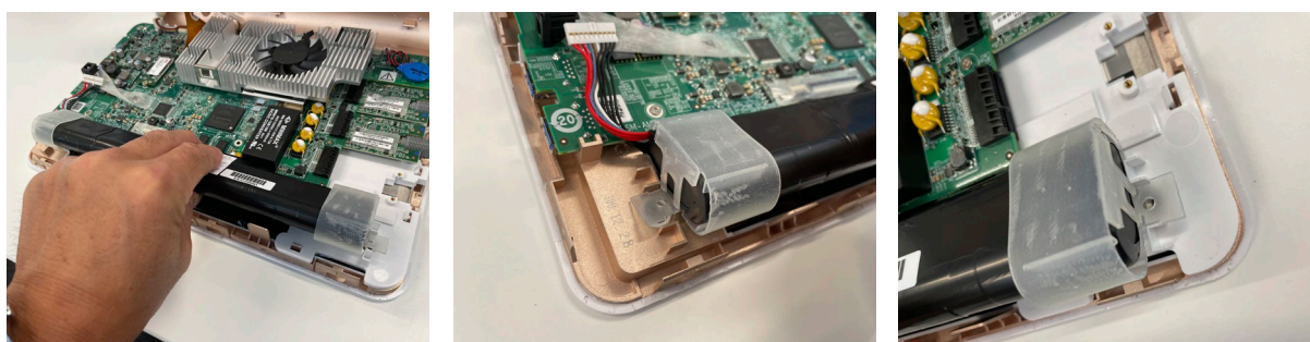
19. ábra: Illessze az akkumulátort a sapkákkal együtt az eszközre
