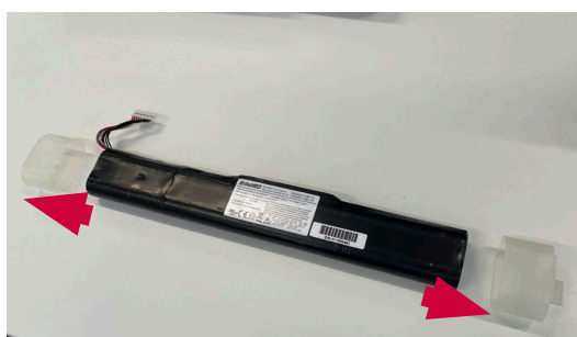
Obrázek č. 17 Opatrné odstranění krytek baterie
