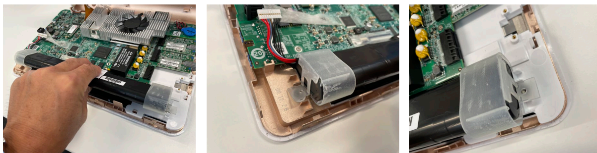
Figur 19 Sæt batteriet med batterihætterne tilbage på apparatet
