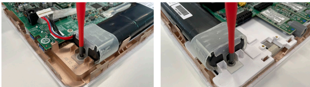
Figura 16 Svitare le viti su entrambi i lati della batteria
