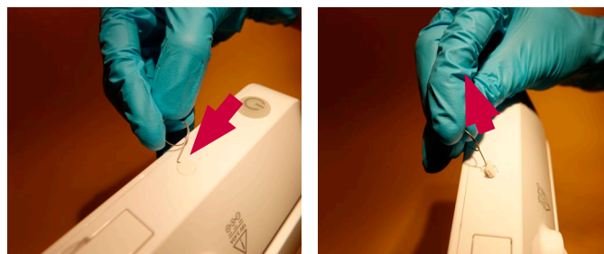
Abbildung 5 Entfernen der Schraubenabdeckung
