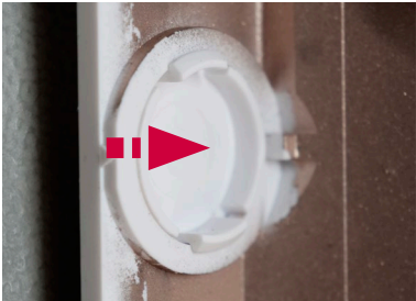
図27 VDIボードが取り外された場合、カバーを取り付ける
