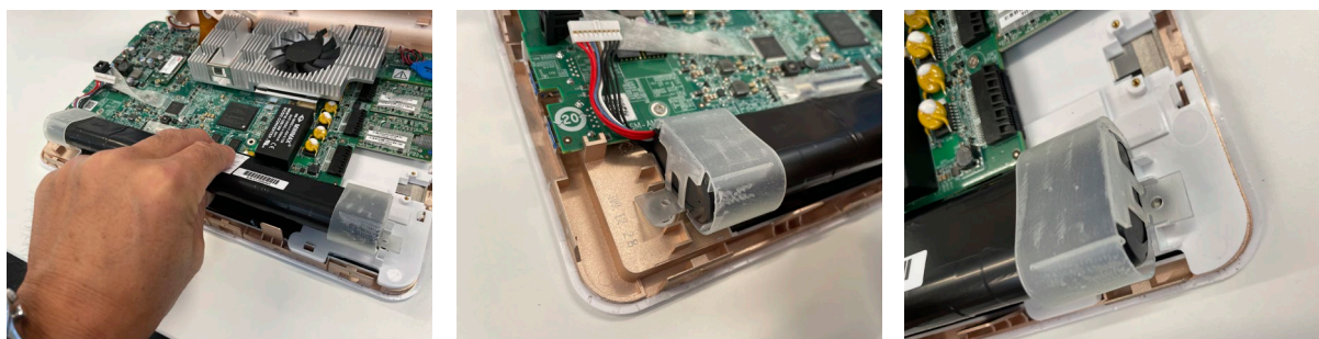
Figura 19 Rimettere sul dispositivo la batteria con i relativi tappi
