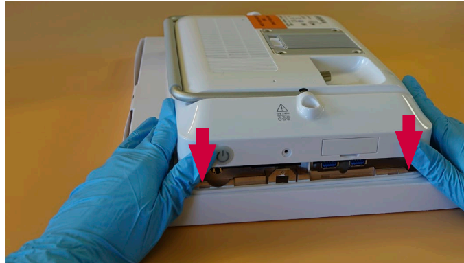
36. ábra: Helyezze fel a hátsó burkolatot – folytatás
