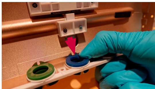
Obrázok 25 Odstráňte poškodený farebný krúžok
