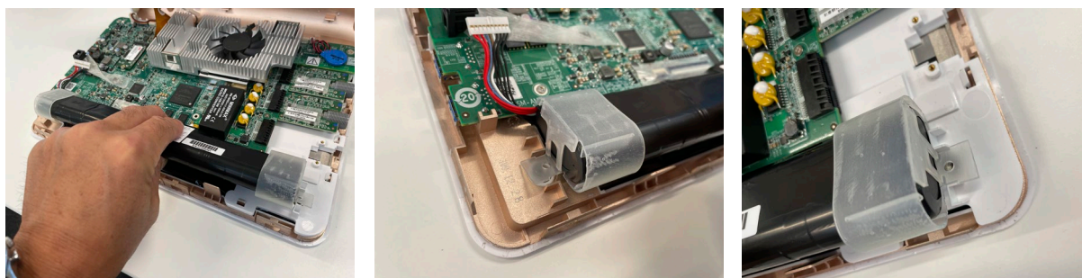
Kuva 19 Asenna akkutulpilla varustettu akku takaisin laitteeseen
