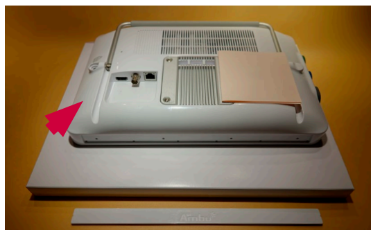
Kuva 8 Aseta näyttöyksikkö näyttö alaspäin
