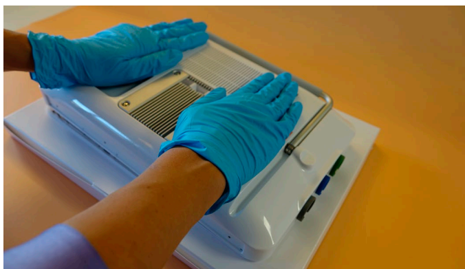
Figur 37 Trykk ned bakdekselet til det klikker på plass
