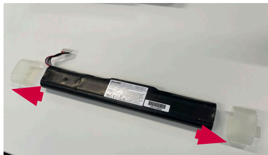
Obrázok 17 Opatrne odstráňte krytky batérie
