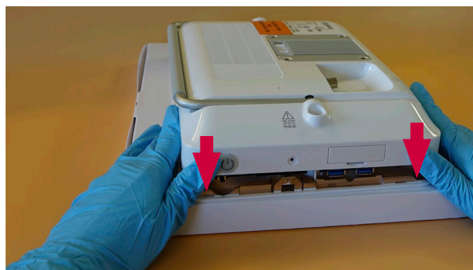
Afbeelding 36 De achterbehuizing plaatsen, vervolg
