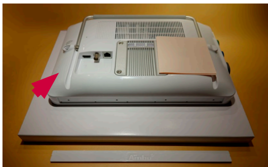
Joonis 8. Allapoole jääva ekraaniga kuvamisüksuse paigutamine
