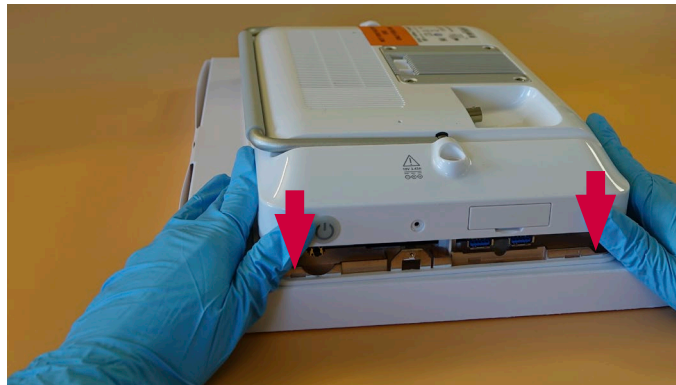
Εικόνα 36 Τοποθέτηση του πίσω περιβλήματος, συνέχεια
