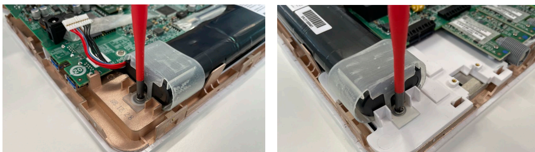
Joonis 16. Aku mõlemal küljel oleva kruvi lahti keeramine
