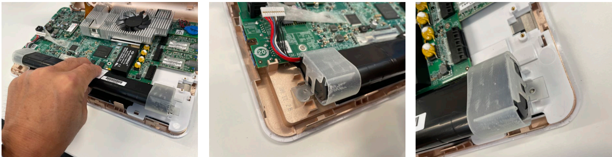
図19 バッテリーキャップのついたバッテリーをデバイスに戻す
