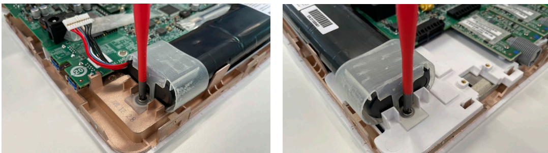
Abbildung 16 Herausdrehen der Schrauben auf beiden Seiten des Akkus
