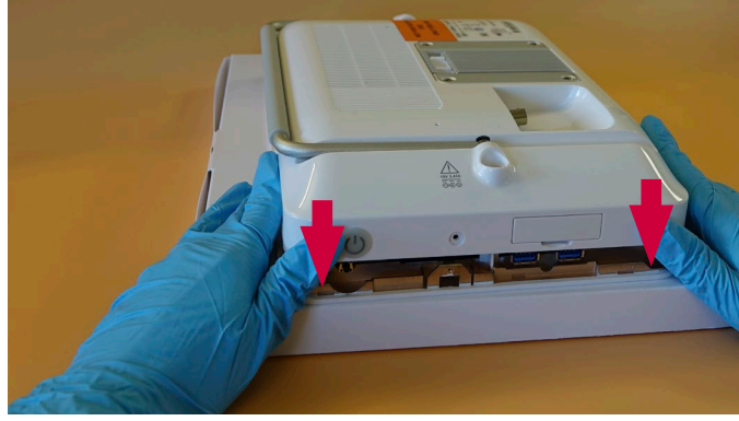
Şekil 36 Arka kasayı yerleştirin, devamı
