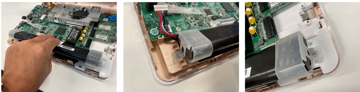
Abbildung 19 Erneutes Einsetzen des Akkus mit den Akkudeckeln in das Gerät
