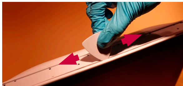
Figura 7: Apertura de la carcasa trasera con la herramienta de púa
