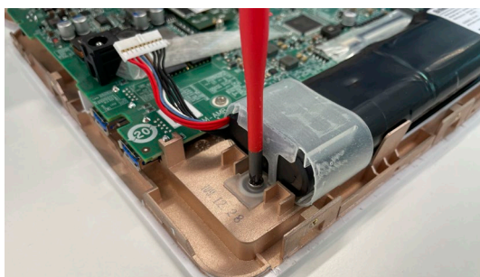
Bild 16 Skruva loss skruvarna på båda sidor av batteriet
