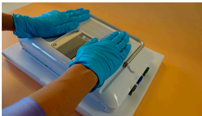
Figura 37 Fazer pressão sobre a caixa traseira até encaixá-la no lugar
