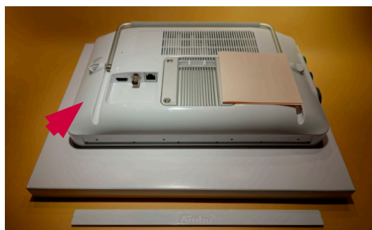
Figur 8 Plasser skjermenheten med skjermen ned
