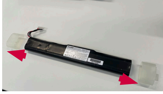
Şekil 17 Batarya kapaklarını dikkatlice çıkarın
