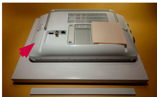
Rysunek 8 Umieszczanie wyświetlacza ekranem do dołu
