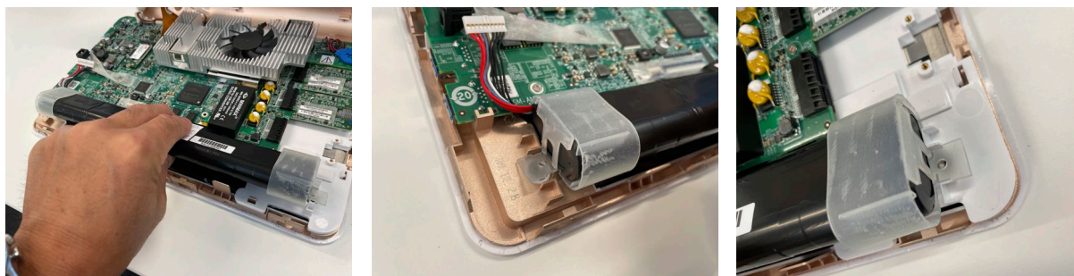
Obrázek č. 19 Vložení baterie s krytkami zpět do zařízení
