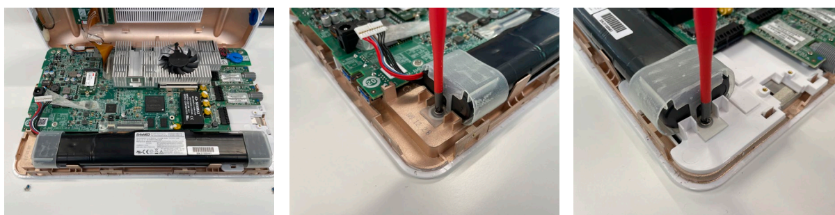
Figur 20 Trekk til de to skruene
