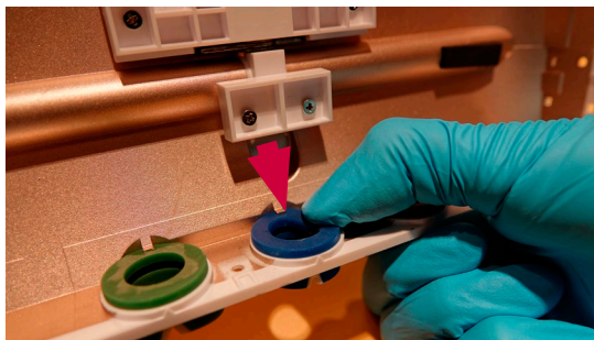
Bild 25 Ta bort den skadade färgringen
