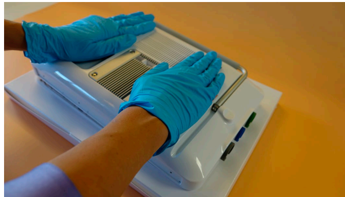
37. ábra: Nyomja lefelé a hátsó burkolatot úgy, hogy a helyére pattanjon
