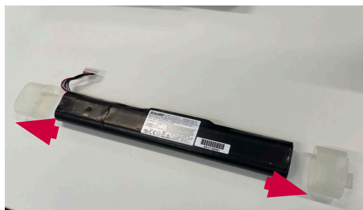
Figur 17 Fjern batteridekslene forsiktig
