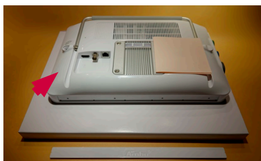
Obrázok 8 Umiestnite zobrazovaciu jednotku smerom nadol
