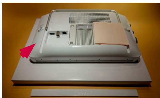
Figure 8 - Placer l'écran face avant vers le bas
