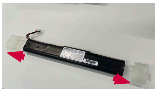
Kuva 17 Irrota akkutulpat varovasti
