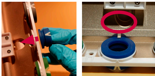
Εικόνα 26 Εισαγωγή νέου έγχρωμου δακτυλίου
