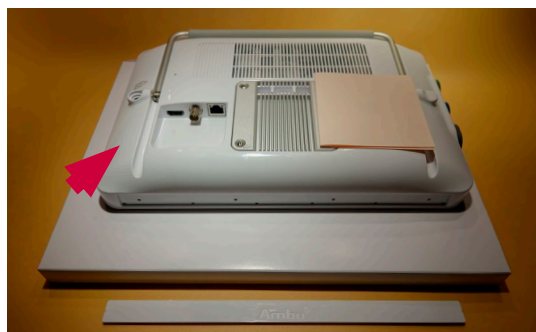
Figura 8 Posizionare l'unità display rivolta verso il basso
