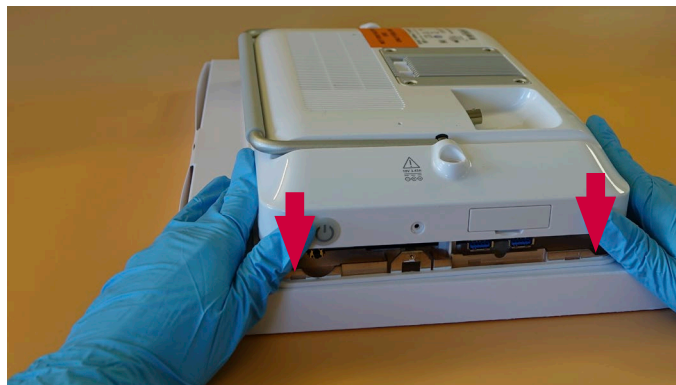
Figura 36 Colocar a caixa traseira, continuação
