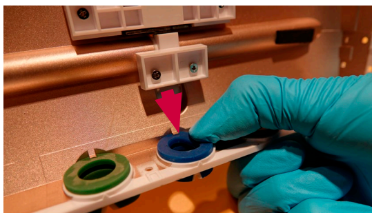
Joonis 25. Kahjustunud värvirõnga eemaldamine
