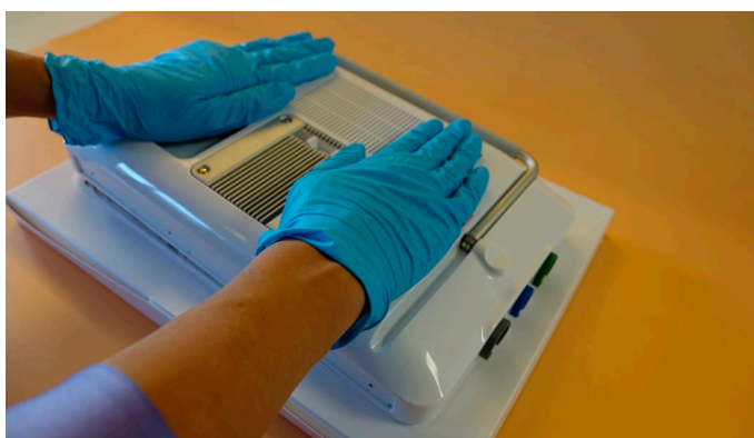
Figura 37: Presión hacia abajo de la carcasa trasera hasta que haga clic y quede fija en su posición
