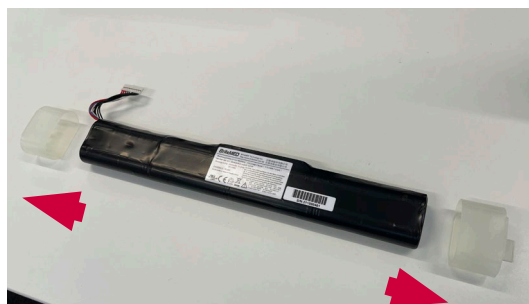
Figura 17 Rimuovere con attenzione i tappi della batteria
