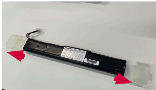
17. ábra: Óvatosan húzza le az akkumulátorsapkákat
