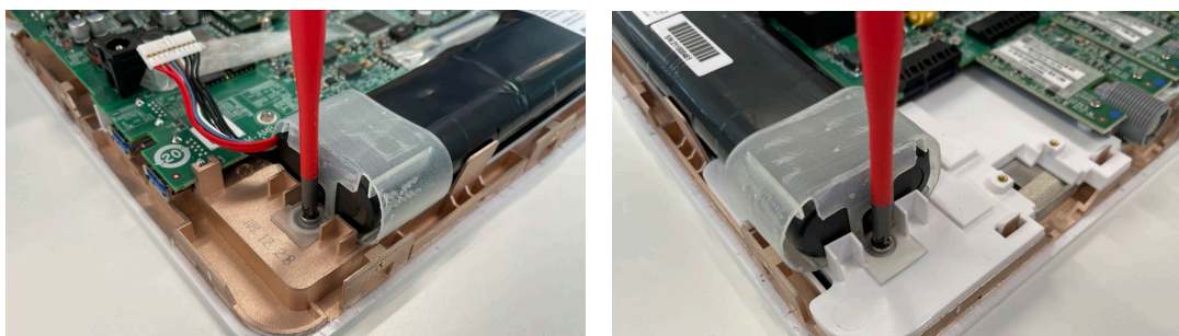
Figura 16: Aflojamiento de los tornillos a ambos lados de la batería
