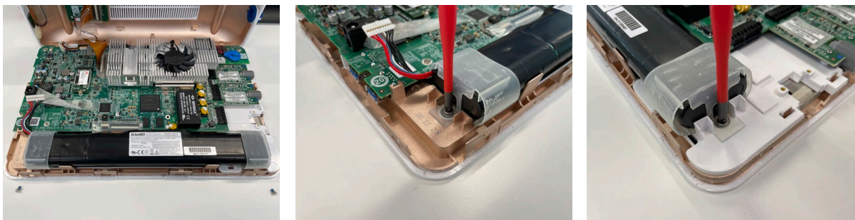
Rysunek 20 Dokręcanie dwóch śrub
