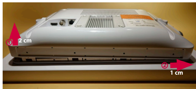
Obrázok 9 Opatrne potiahnite zadný kryt nahor a posuňte ho mierne doprava
