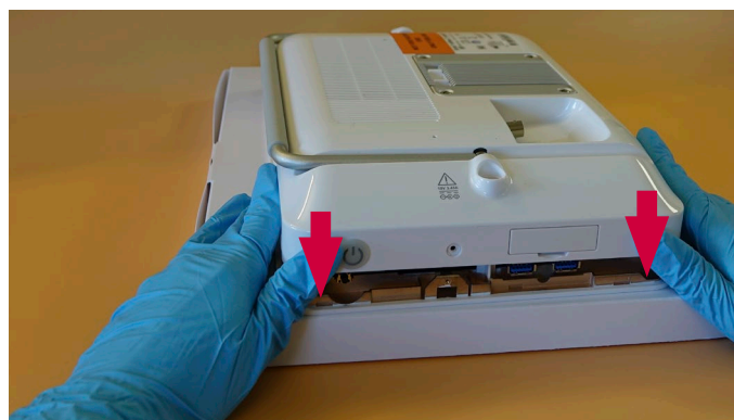
Rysunek 36 Zakładanie tylnej obudowy, ciąg dalszy
