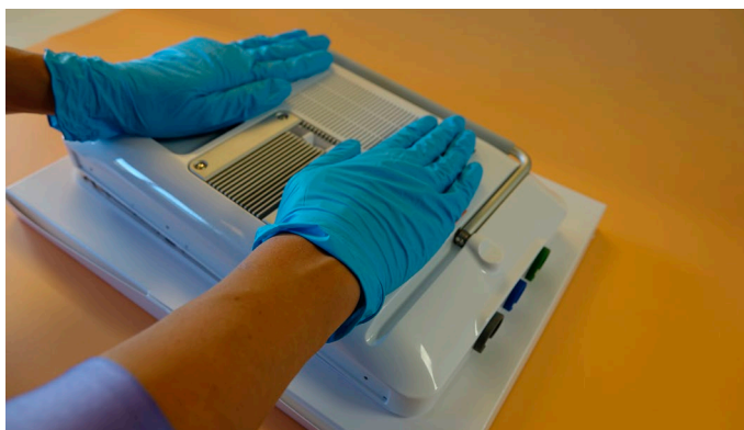
Figure 37 - Appuyer sur le boîtier arrière jusqu'à ce qu'il s'enclenche
