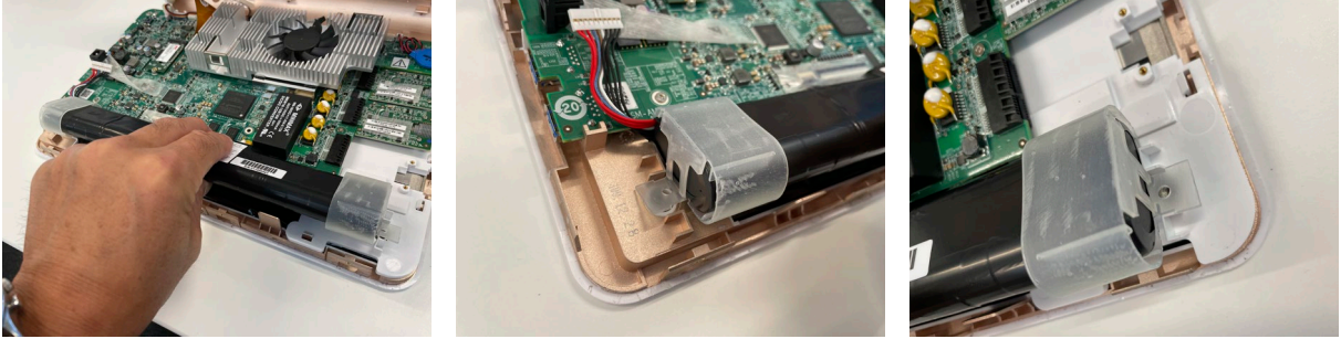
Şekil 19 Bataryayı, batarya kapaklarıyla birlikte tekrar cihazın üzerine yerleştirin
