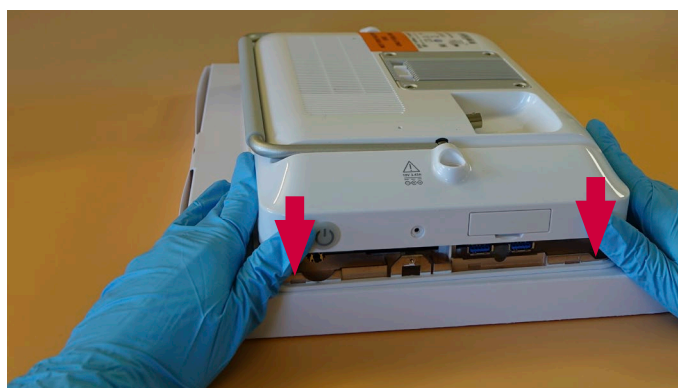
Figure 36 - Mise en place du boîtier arrière (suite)
