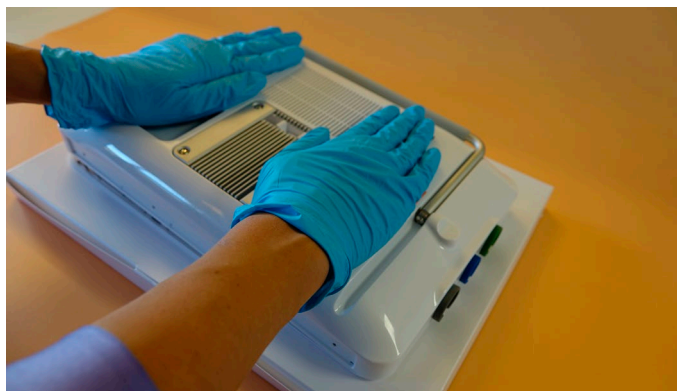
Abbildung 37 Drücken Sie die rückseitige Verkleidung nach unten, bis sie einrastet
