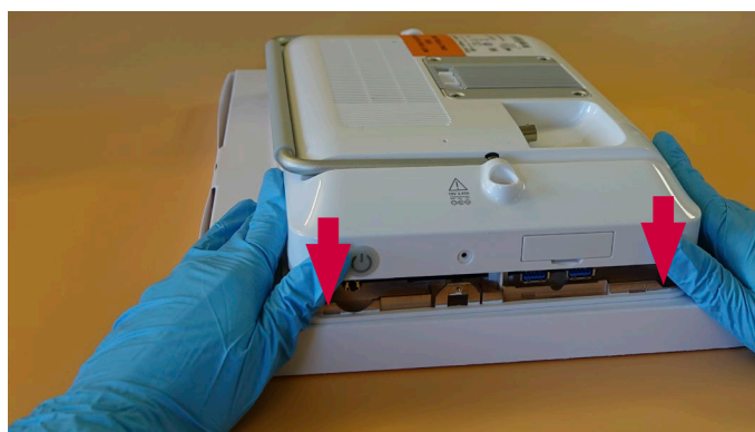
Figura 36: Colocación de la carcasa trasera (continuación)
