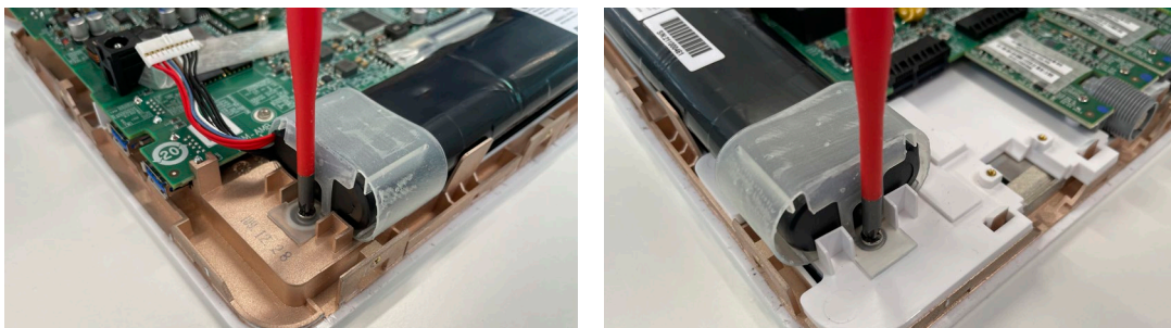
Figur 16 Skru løs skruene på begge sider av batteriet
