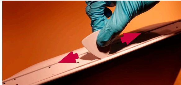
Şekil 7 Plektrum aracıyla arka kasayı çıkarma
