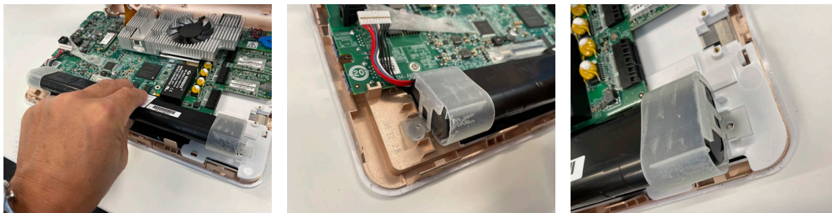
Bild 19 Sätt tillbaka batteriet med batterilocken i enheten
