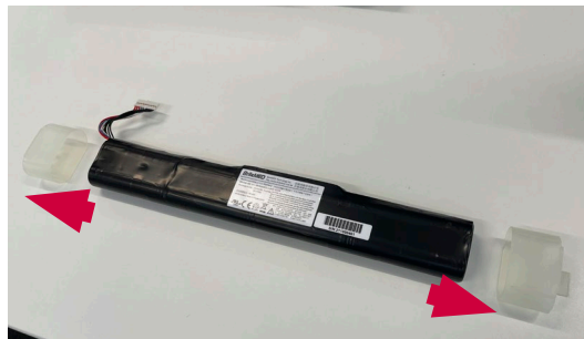
Afbeelding 17 Verwijder de batterijdoppen voorzichtig
