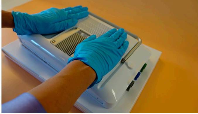
Şekil 37 Yerine oturana kadar arka kasaya bastırın
