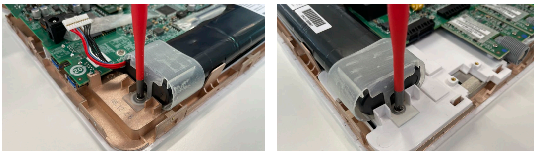
Rysunek 16 Odkręcić śruby po obu stronach baterii
