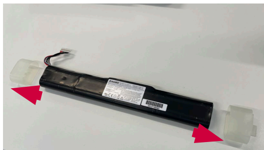
Figura 17: Retirada con cuidado de las tapas de la batería
