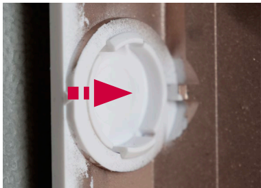
图 27 拆除 VDI 板后安装连接器盖
