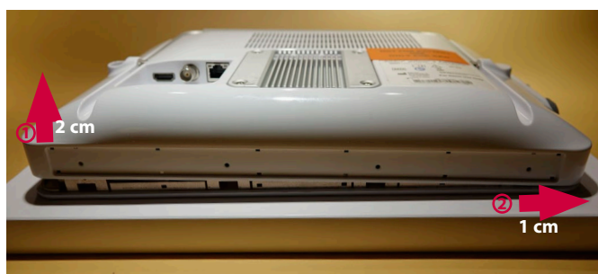
图 9 小心向上拉动后壳，将其稍微向右滑动
