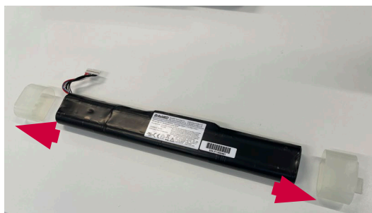
Figure 17 - Retrait des capuchons de la batterie avec précaution
