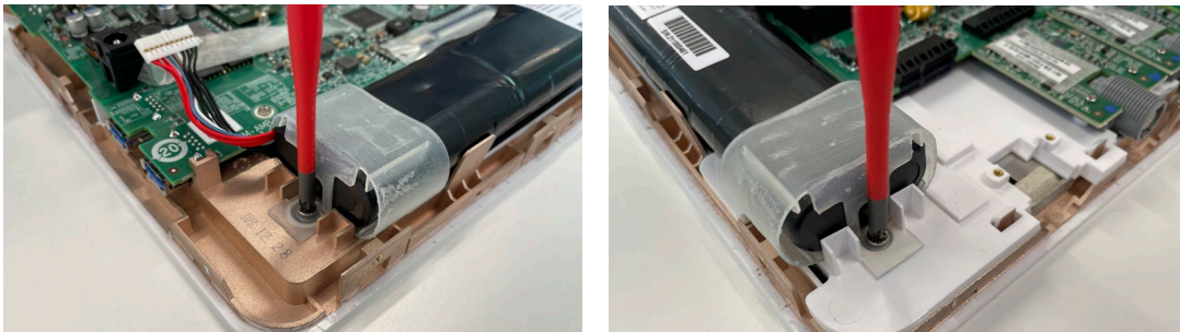
Figure 16 - Dévissage des vis des deux côtés de la batterie
