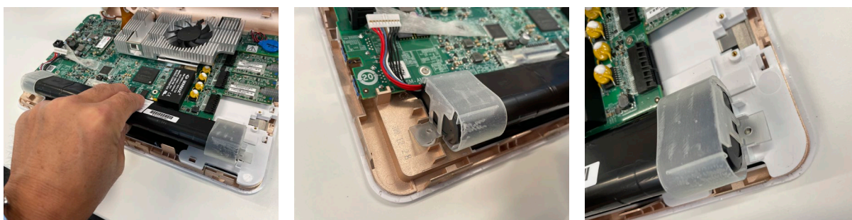
Figura 19 Colocar a bateria com as tampas da bateria de volta no dispositivo
