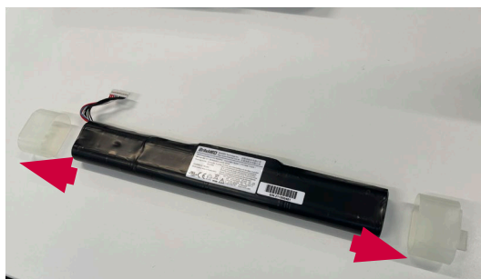
Εικόνα 17 Αφαιρέστε προσεκτικά τα καλύμματα μπαταρίας
