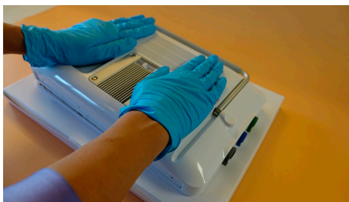
Figur 37 Tryk bagbeklædningen ned, indtil den klikker på plads
