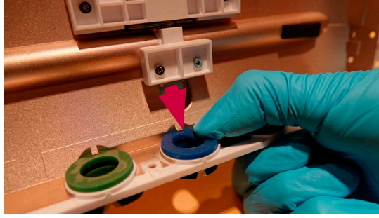
Şekil 25 Hasarlı renkli halkayı çıkarma
