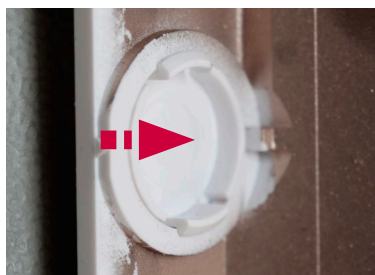
Bild 27 Sätt dit täcklocket om VDI-kortet har tagits bort
