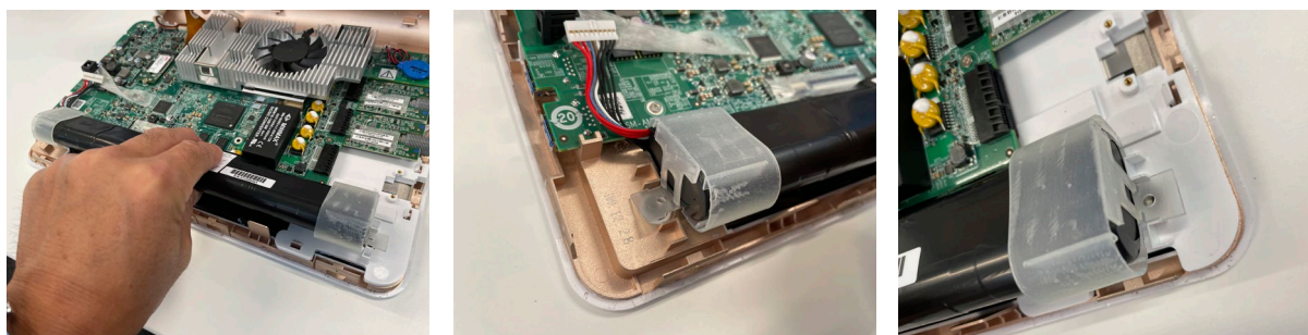
Εικόνα 19 Τοποθέτηση της μπαταρίας με το κάλυμμα μπαταρίας στη συσκευή
