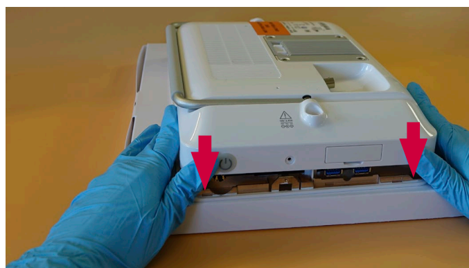
Kuva 36 Takakotelon laittaminen paikalleen, jatkuu
