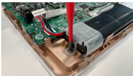
Obrázok 16 Odskrutkujte skrutky na oboch stranách batérie
