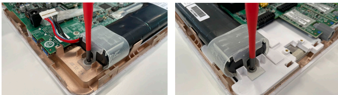
Figur 16 Skru skruerne på begge sider af batteriet ud
