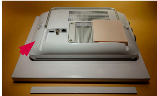
Şekil 8 Görüntüleme ünitesini aşağı bakacak şekilde koyun
