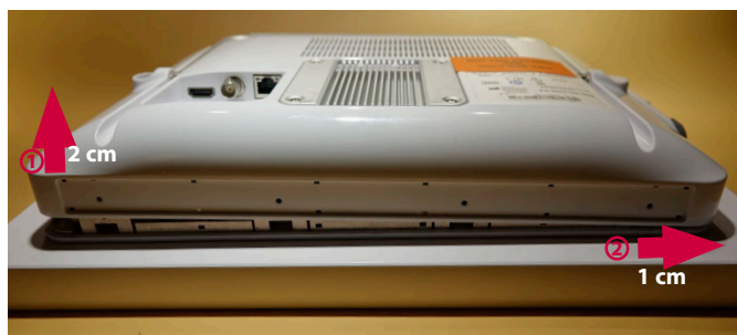
Joonis 9. Korpuse tagakülje üles tõstmine ja veidi paremale nihutamine
