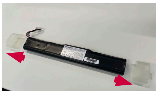
Rysunek 17 Ostrożnie zdjąć nakładki baterii
