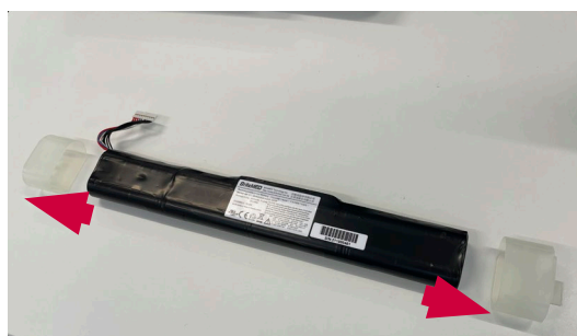
図17 バッテリーキャップを慎重に外す
